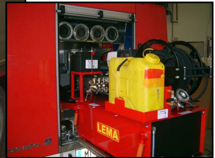
LEMA HFG Benzin - Fahrzeugeinbau mit Tank und 60m Hochdrucklösch-Schlauch
