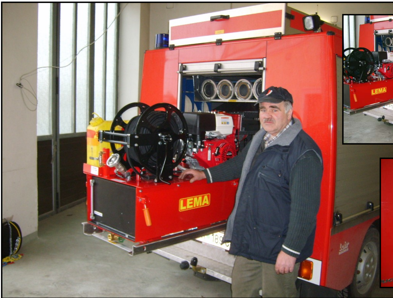
LEMA HFG Benzin - Fahrzeugeinbau mit Tank und 60m Hochdrucklösch-Schlauch
