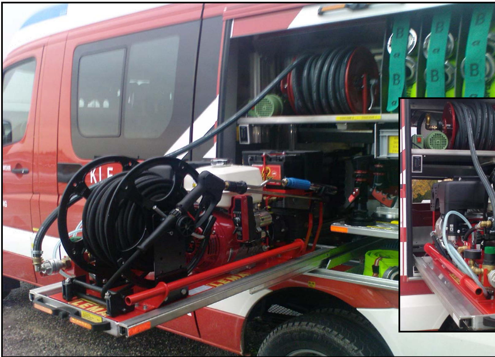
LEMA HFG Benzin - Fahrzeugeinbau Tank im Fahrzeugunterbau, 60m Hochdrucklösch-Schlauch und abnehmbarem (tragbarem) HFG mit Wasserzulaufpumpe. Fahrzeug: Mercedes Sprinter der FF - Reichraming
