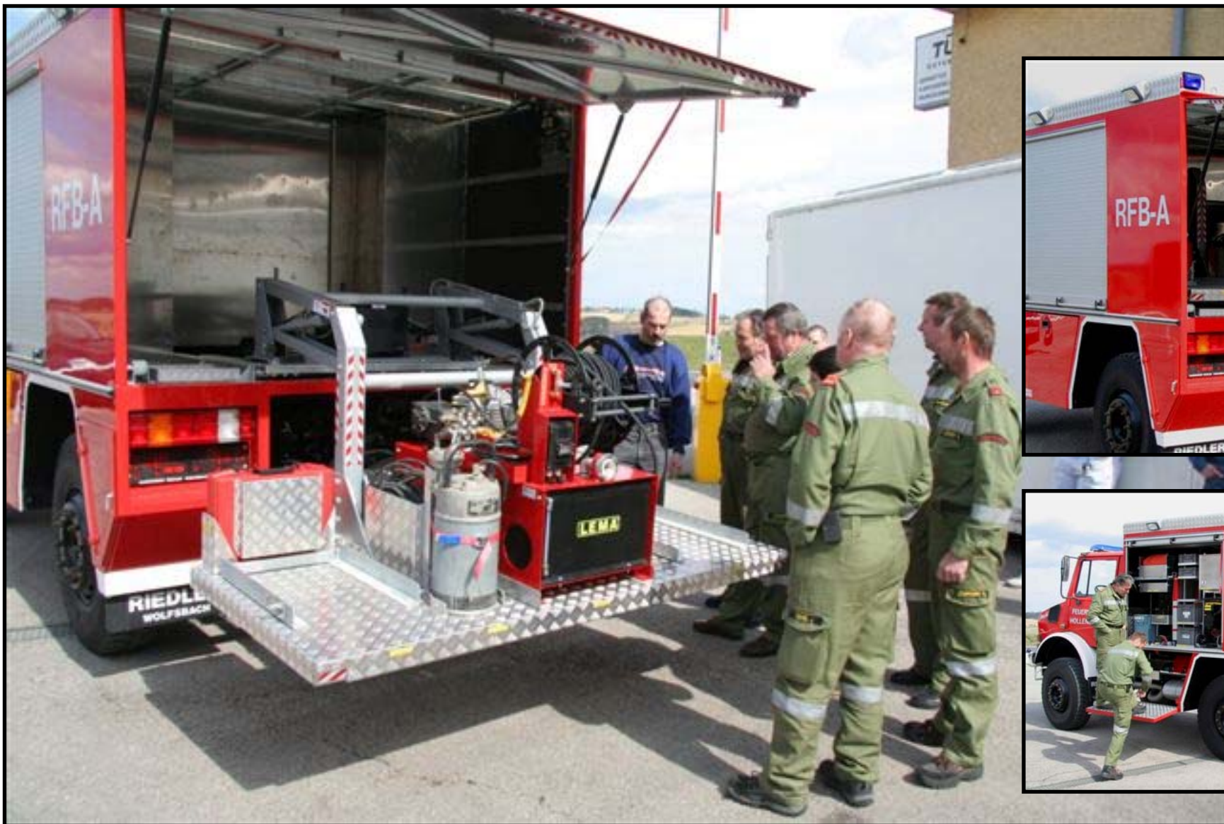
LEMA HFG Elektro - Fahrzeugeinbau mit integriertem Tank und 60m Hochdrucklösch-Schlauch Fahrzeug: Unimog der FF - Hollenstein
