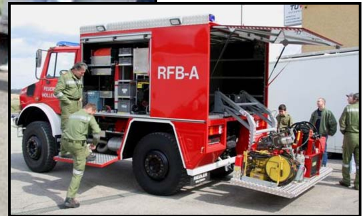
LEMA HFG Elektro - Fahrzeugeinbau mit integriertem Tank und 60m Hochdrucklösch-Schlauch Fahrzeug: Unimog der FF - Hollenstein
